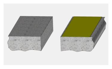
Первой устанавливается узкая планка шва ДШ-НО. Крепится при помощи крепежа. Крепеж устанавливается на расстоянии от 3,5 см от края профиля с шагом 25-35см.
