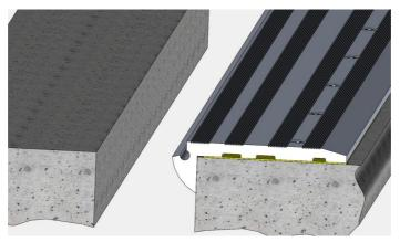
4) Подвижная планка деформационного шва ДШ-НО с торца вставляется в закрепленную планку, предварительно проверив наличие уплотнительных резинок в пазах. Данная планка остается незакрепленной механически и имеет возможность перемещаться в вертикальном направлении вверх-вниз. Также за
